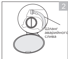
Выньте шланг аварийного слива, вытащите заглушку
