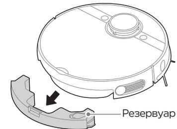
3. Откройте крышку резервуара, залейте воду, закройте крышку.
