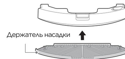
5. Установите блок влажной уборки в корпус пылесоса до щелчка.
